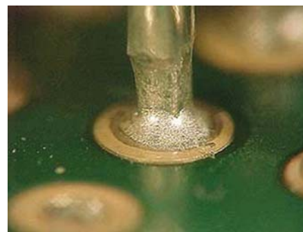
Рис. 3. Контактная площадка, не полностью покрытая бессвинцовым припоем Sn/Cu
